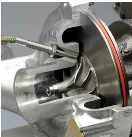
Mesure de vitesse de rotation pour turbocompresseur
