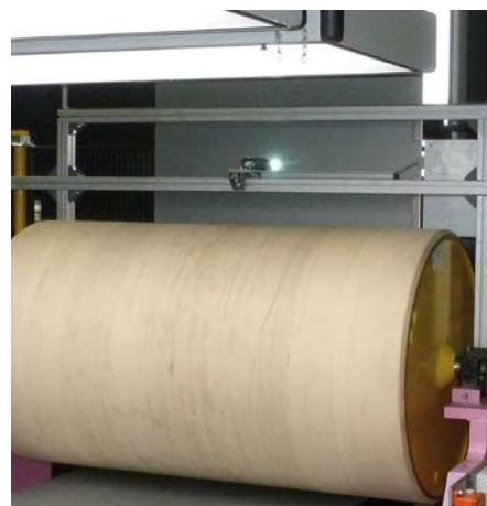
Mesure de couleur sur une bande sans fin revêtue telles que l'aluminium, le zinc ou le papier pendant la production.
