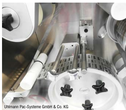
Détection des corps étrangers MDS sert à détecter les corps étrangers dans les machines d'emballage sous blister pour le conditionnement des comprimés.
