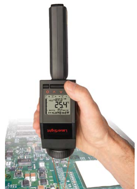
Recherche et développement Mesure de température par infrarouge de haute précision sur des composants SMD. Zone de mesure d'un mm 2 seulement.
