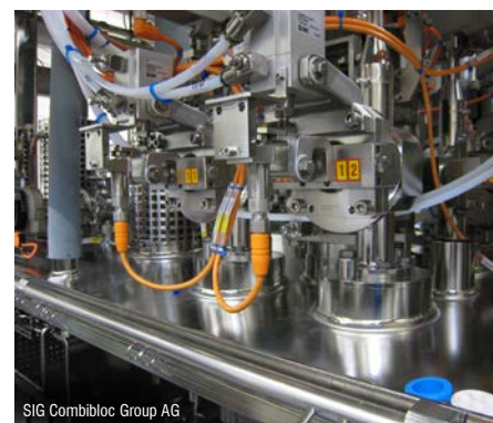
Mesure de la levée de soupape Les boîtiers étanches en acier des séries MDS-45-Mxx sont parfaits dans l'industrie agroalimentaire.
