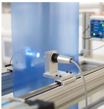
Mesure du dégradé de couleur en ligne des films transparents et des verres acryliques.
