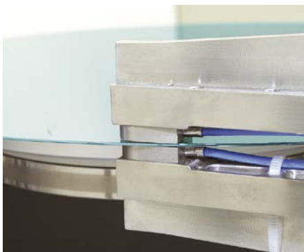
Mesure d'épaisseur des tranches de silicium à l'aide de deux capteurs capacitifs.
