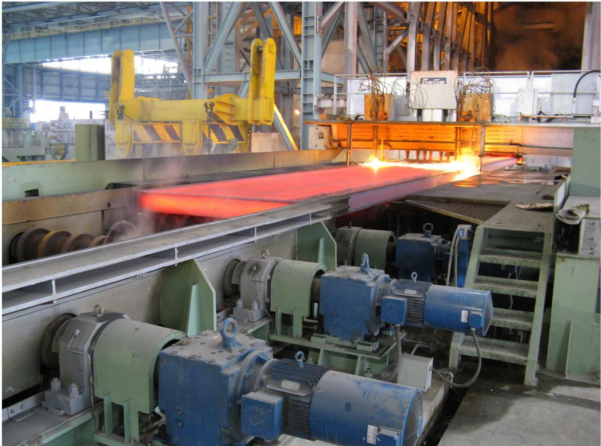
*Les motoréducteurs NORD Drivesystems entraînent les convoyeurs à rouleaux sans temps d'arrêt*
