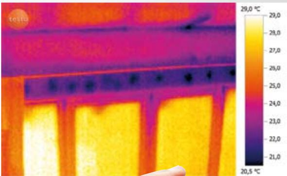
Elles permettent l'enregistrement et la documentation des déperditions thermiques sur les fenêtres et portes extérieures, les coffres de volet roulant, les niches des radiateurs, mais également au niveau du toit ou sur l'ensemble de l'enveloppe du bâtiment.
