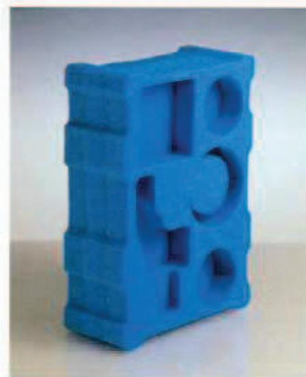
Mousse polyuréthane usinée par fraisage sur commande numérique.
