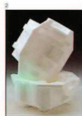
1. Mousse ferme de polyéthylène usinée. Outre la fonction de calage et d'amortissement, son aspect permet de réaliser des intérieurs de valises ou de conteneurs de grande qualité pour présentation de matériel.
