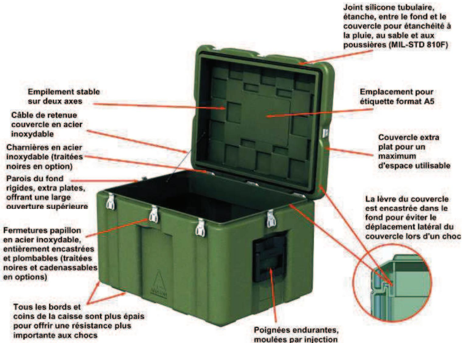
Coque en polyéthylène haute densité pour accroître la résistance et l'absorption des chocs.
