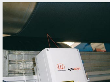
Mesure d'épaisseur de bandes de caoutchouc noir pour l'industrie du bâtiment
