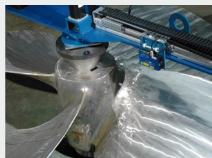
Mesure de profil d'hélice de bateaux
