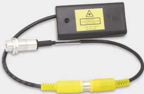
Outil auxiliaire à la visée laser TM-LST-CT, fonctionnement par batterie (2 x alcalines AA), pour l'alignement des capteurs CT (cotes identiques à celles du capteur CT)
