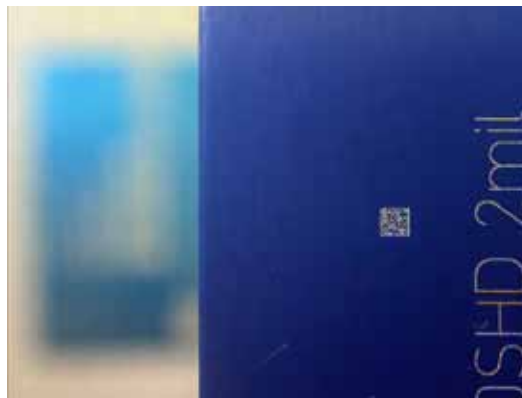
L'objectif liquide s'ajuste pour un petit code Data Matrix rapproché, ci-dessus, et ci-dessous il peut faire la mise au point sur des codes-barres éloignés.
