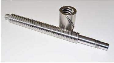
La vis roulée avec son écrou ( $\varnothing 40 \times 40$ ) avant le montage.
