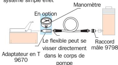
Branchement de pompes à air, électriques et à essence avec système de valve
