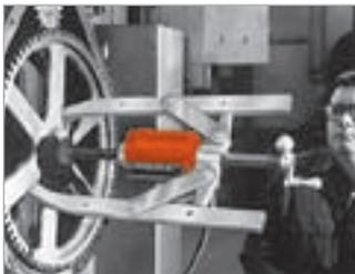
Les 2 griffes de l'extracteur passent à travers les rayons de la roue dentée pour la saisir au moyeu. Une pompe manuelle fournit la puissance hydraulique.
