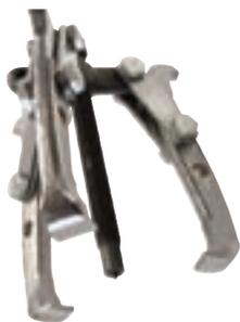
**Extracteurs à griffes:** Manuels ou hydrauliques. Pour plus de puissance et de facilité, utiliser un modèle hydraulique. Les deux types sont disponibles avec des configurations à 2 ou 3 griffes, et s'utilisent pour agripper la circonférence externe d'une pièce, ou avec un accessoire d'extraction interne pour roulement ou poulie par exemple. (pages 204-205, 218-219, 220-221, 230-231)
