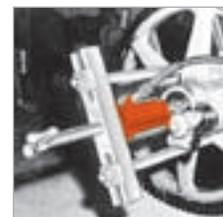
Dépose d'un pignon avec un extracteur-poussoir hydraulique Push-Puller<sup>®</sup>. Un accessoire d'extraction fournit la surface d'appui.
