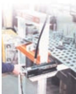
Commande manuelle pompe PA9H utilisée avec une presse capacité 25 Tonnes.
