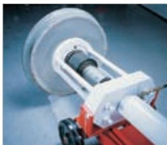
La photo ci-dessus montre l'extracteur universel en position devant un roulement à rouleaux prêt à être déposé.
