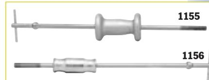
**Extracteurs à inertie à griffes réversibles** – Convienent parfaitement pour extraire des pignons, des roulements, des bagues extérieures, des joints, etc. Deux ou trois griffes peuvent être utilisées et positionnées pour réaliser des extractions « intérieures » ou « extérieures ». Les accessoires ou les raccords peuvent être fixés à l'extrémité filetée 5/8"-18.
