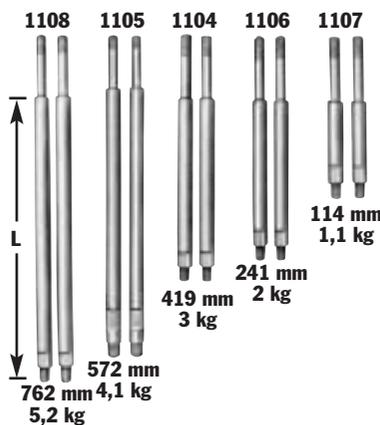
**REMARQUE:** L = longueur de tirant : 114 mm, 241 mm, 419 mm, 572 mm et 762 mm ; soustraire 124 mm à la longueur de tirant pour déterminer la portée en cas d'utilisation de capuchons de tirant.
