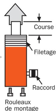
Remarque : Pour les vérins double effet, l'huile à l'extrémité du vérin doit être soustraite pour déterminer la capacité.
