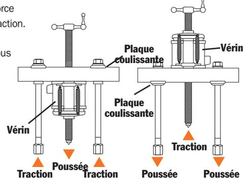
**Sélection et capacité nominale** – La «capacité» spécifiée de chaque extracteur-pousseur est déterminée en utilisant ses tirants standard en tension. L'emploi de tirants plus longs ou en compression diminue cette capacité. Toujours choisir l'extracteur-pousseur le plus puissant muni des tirants les plus courts convenant à la tâche.
