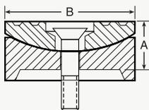
Réduisent l'effet de l'excentrage des charges. Angle maximum de 5 degrés. Des rainures radiales sur la tête réduisent la possibilité de glissement des charges. Une encoche transversale sur la face de chaque tête aide à tenir centrée une charge avec une surface irrégulière ou une charge sphérique.
