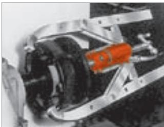
Dépose de son arbre d'un accouplement flexible de moteur électrique avec un extracteur 2 griffes.
