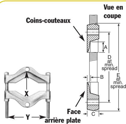
L'extracteur se cramponne dans la gorge en V pour répartir la charge. À utiliser avec les extracteurs Grip-O-Matic® ou les extracteurs-pousseurs Push-Pullers®.
