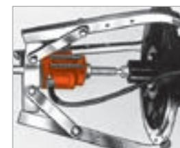
Les 3 griffes de l'extracteur maintiennent la pièce tandis que la pompe manuelle hydraulique fournit la puissance de poussée pour l'extraction d'un arbre de son logement. Un embout de protection est posé à l'extrémité de la vis de force.
