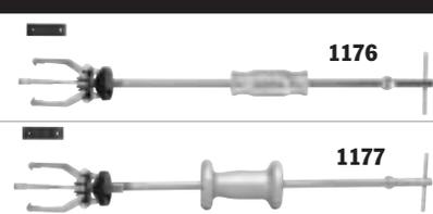
**Extracteurs à inertie avec accessoires pour enlèvements de cuvettes** – Il s'agit d'une combinaison d'une masse coulissante de base avec l'extracteur à prise interne réf. 1152 pour l'extraction hors des trous borgnes de joints, bagues extérieures et cuvettes de roulements.
