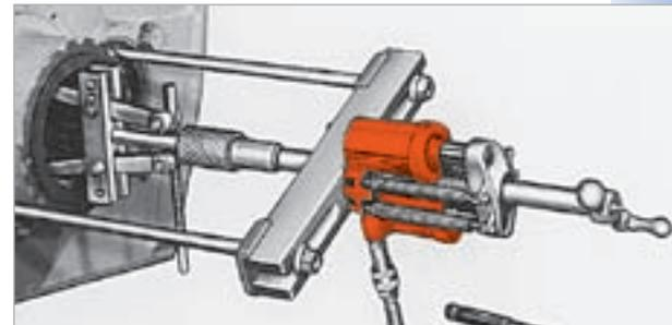
Montage composé d'un extracteur-poussoir Push-Puller<sup>®</sup> de 50 tonnes et d'un accessoire d'extraction de cuvette pour la dépose d'un joint d'essieu.
