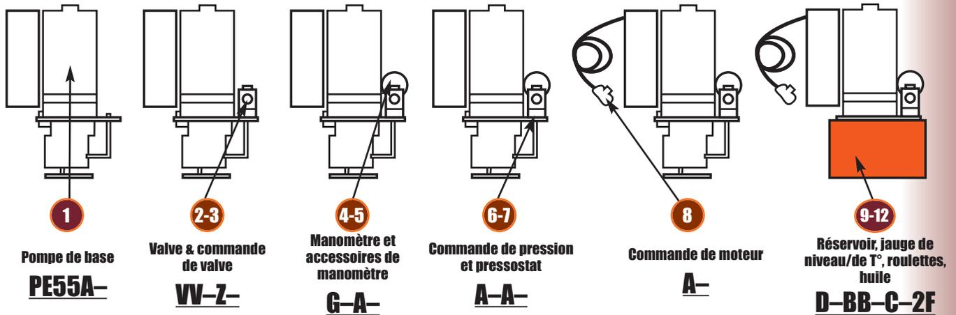
La pompe réf. PE55A-VV-Z-G-A-A-A-D-BB-C-2F est une pompe 700 bars à deux vitesses, avec un moteur monophasé de 115 volts, 50-60Hz de 1,12 kW fonctionnant à 12 000 tr/min., munie d'une électrovalve 4 voies réf. 9512 avec commande à distance manuelle réf. 202778, manomètre réf. 9041 sans accessoires, contrôle
