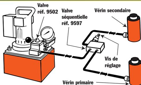
**6** Vérin double effet avec une valve séquentielle commandant le circuit principal et secondaire des vérins.
