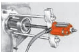
Montage type pour la dépose d'un arbre de pignon d'entraînement. La vis de force est fixée à l'arbre par un raccord fileté. L'arbre est maintenant prêt pour une extraction hydraulique.
