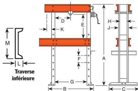
Le dispositif à ouverture latérale permet de monter le vérin à l'extérieur du bâti de la presse pour l'enlèvement rapide de roulements ou d'autres travaux.
