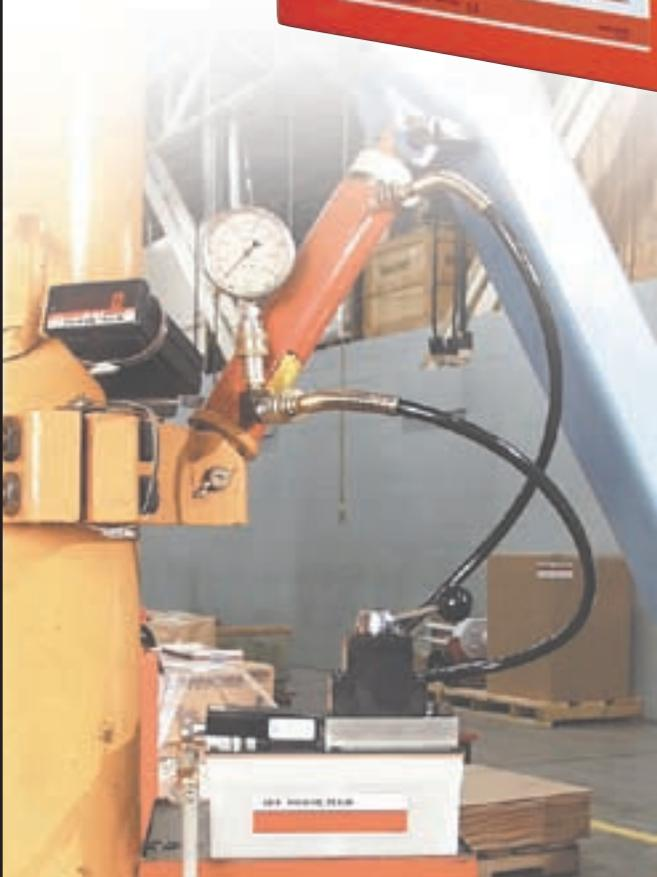
Pompe PA6D et vérin de 25 tonnes utilisés pour une fixation test.
