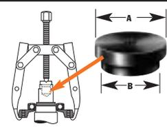
**Jeu d'embouts de protection** - Les embouts de protection de Power Team ont été conçus pour protéger les arbres de la distorsion lorsque de fortes pressions sont appliquées avec les extracteurs à griffes ou les extracteurs-pousseurs Push-Pullers®. Les embouts de protection s'insèrent entre l'extrémité de la vis d'extracteur et l'arbre.
