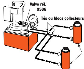
**3** Vérin simple effet avec commande par une valve montée à distance.
