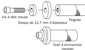
Ces jeux comportent l'outillage adéquat pour chaque travail de pose d'un joint, roulement ou bague. Il suffit de choisir les disques de la taille adéquate, de les fixer à la poignée avec les vis à tête creuse, et de frapper avec un marteau.
