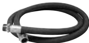
**Réf. 9785** – Flexible, 19,1 mm de dia. int. avec raccords mâles 3/4" NPTF aux deux extrémités. 3 m de long. Pression de travail 155 bars. (2 sont nécessaires sur les testeurs de 200 et 300 L/min.) Poids 0,3 kg.
