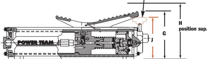
Réglage de la valve de décharge : jusqu'à 700 bar
