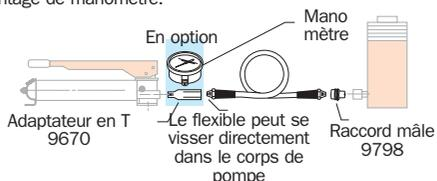
Branchement d'une pompe pneumatique système simple effet
