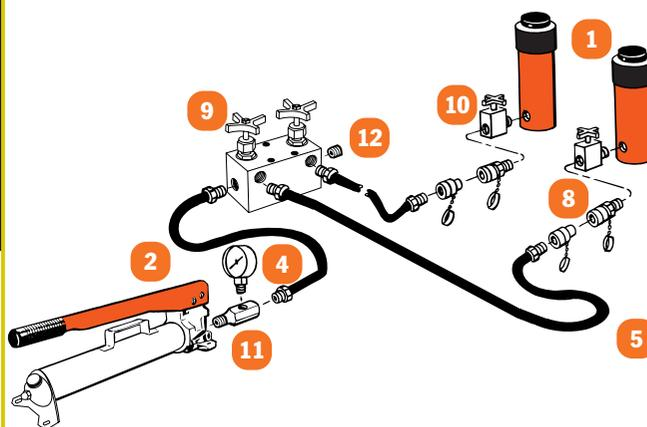
**Système de base double effet comprenant une pompe hydroélectrique, des valves d'arrêt, des valves d'abaissement de charge et plusieurs vérins double effet.**
