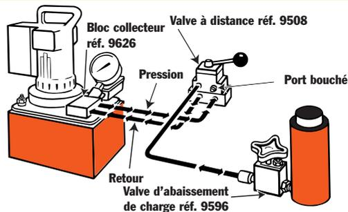
**4** Vérins double effet avec commande par une valve montée à distance.
