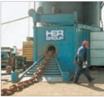
**Pompe PE4004S et vérin RD3006 utilisés avec une presse spéciale pour la réparation de maillons de chaîne de l'industrie navale.**
