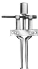
**Les accessoires d'extraction interne** ont des griffes étroites qui s'écartent dans la partie centrale de la pièce à extraire. Ils permettent une traction rectiligne et évitent les dommages aux logements. Griffes réglables permettant d'adapter les accessoires à différents diamètres. (page 208)
