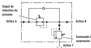
**ATTENTION:** La pression de service doit être supérieure à la pression pré-réglée par la valve 9608.
