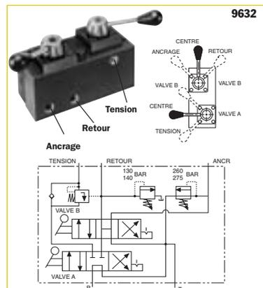
Valve manuelle montée sur pompe, 6 positions et 5 voies. Valeur de la pression à la valve « A » de 700 bar, à la valve « B » de 420 bar. Pression maxi de carter de valve : 35 bar.
