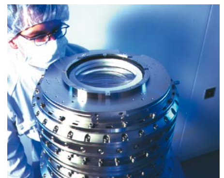
Ajustage au nanomètre près de lentilles dans des objectifs destinés à la réalisation de masques de wafers à l'aide de capteurs de déplacement capacitifs sans contact capaNCDT.
