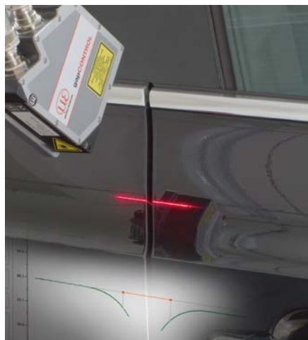
Mesure de fentes et de planéité sur pièces de carrosserie
