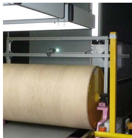
Mesure de couleur de la bande en zinc. L'inspection de couleur en ligne réduit le rebut au minimum.
