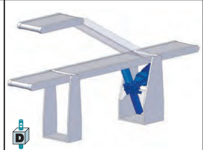
Réglage en hauteur d'une bande transporteuse
