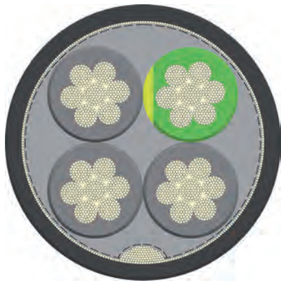
Structure symétrique avec conducteur de protection divisé en trois parties
