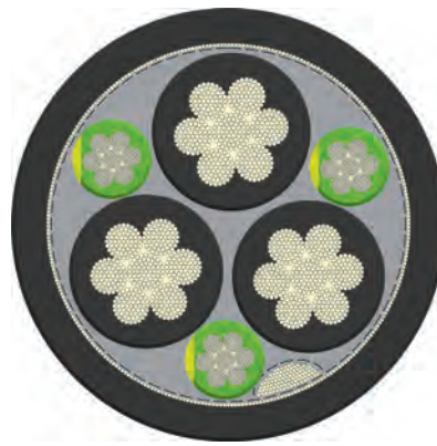
Structure asymétrique avec un conducteur de protection
