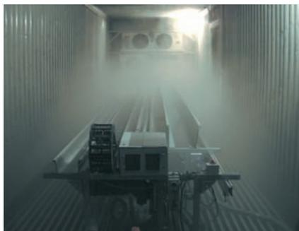
La chambre climatique igus® permet d'effectuer des séries de tests pour Chaînes Porte-Câbles et câbles Chainflex® entre +60° et -40°C
