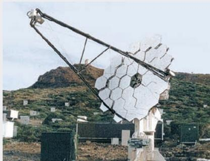
Réglage des réflecteurs du télescope effectué par des rotules lisses quasi sans jeu. Les influences magnétiques sont évitées grâce aux paliers appliqués en pur plastique.
