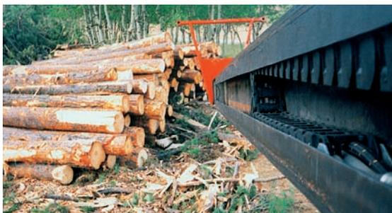
**Chaînes igus® avec conduits hydrauliques sur une machine à écorcer les arbres**
