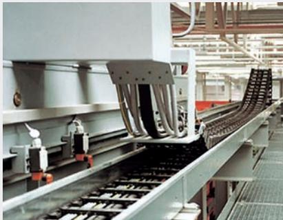
Goulettes igus en acier en utilisation dans la robotique.
