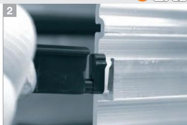
Clipser des deux côtés l'élément de raccordement en polymère dans le logement prévu à cet effet
