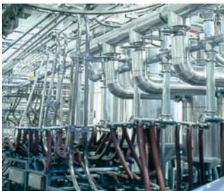
**Usine igus® : installation automatique de mélange et de transport pour igumid G**
