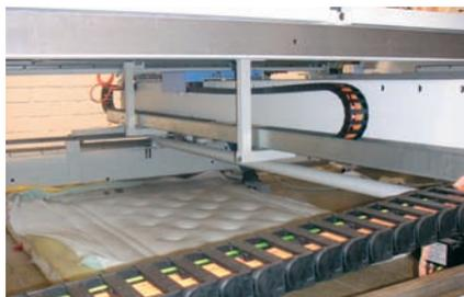
Chaînes igus® E4 confectionnées dans un système de déplacement X/Y à cycles élevés dans le secteur textile
