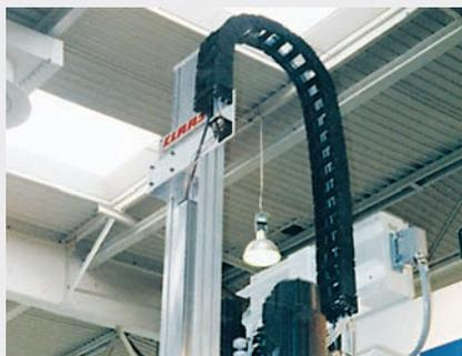
Système E4 dans une installation verticale avec élément de fixation KMA rigide.
