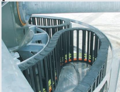
Installation d'une série E4/4 "RBR" dans un télescope à miroir, qui est exposé à la neige et au sable.
