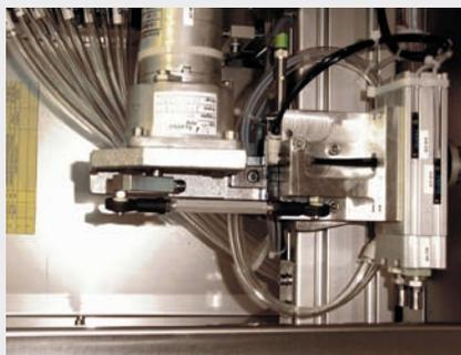
Réglage et changement rapide et flexible du format grâce aux guidages linéaires DryLin® T, sans lubrifiant et économiques.
