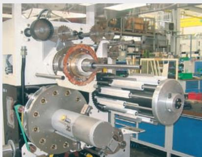
Les guidages linéaires DryLin® R ne nécessitent aucun lubrifiant et sont résistants au brouillard de peinture.
