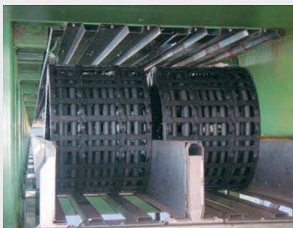
Système E4 avec flasque intermédiaire sur une grue de déchargement de bateaux. Course 105 m, vitesse 240 m/min, poids de câbles 53 kg/m.
