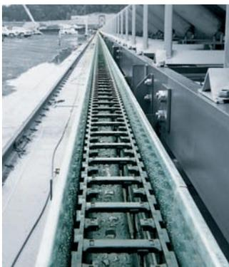
Installation de convoyage dans une carrière, course de 179 m, vitesse de 67 m/min, masse de remplissage de 8 kg/m
