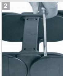
Placer un tournevis dans la rainure de la partie latérale et détacher en faisant levier
