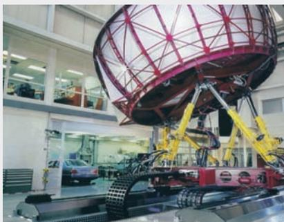
Simulateur de conduite avec Chaîne Porte-Câbles série E4 : les tuyaux hydrauliques pèsent plus de 60 kg/m.
