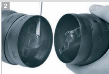
Enfoncer l'ouverture avec un tournevis (point de rupture repéré), introduire le tournevis de 5 mm entre la cuvette et la rotule et ouvrir en faisant levier dans le sens inverse des aiguilles d'une montre
