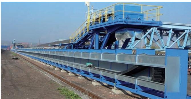
615 m, la plus longue course réalisée au monde avec des Chaînes igus® et des câbles Chainflex®
