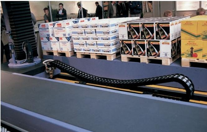
Exemple d'application autoportante avec flèche  $FL_B$
