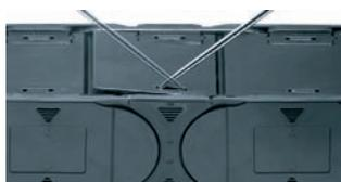
Démontage du couvercle/fond de la Gaine : enfoncer verticalement la rainure du couvercle/fond avec un tournevis et ouvrir en faisant levier
