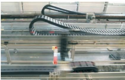
Test des composants : test de la force de traction et de poussée des Chaînes Porte-Câbles igus®.  $v = 10 \text{ m/s}$ ,  $a = 200 \text{ m/s}^2$
