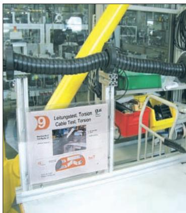
Essai de torsion CF-ROBOT
