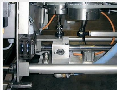
Décorer les pralines sans la présence de produits lubrifiants grâce à l'utilisation d'embouts à rotule igubal®.
