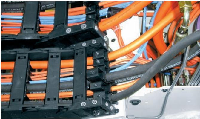
Serre-câbles igus® Chainfix dans un élément KMA, utilisé ici pour câbles et conduits
