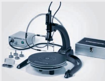
Le positionnement vertical du dispositif optique est effectué par le guidage linéaire DryLin® T. Le jeu réglable assure la précision requise et garantit un fonctionnement silencieux.
