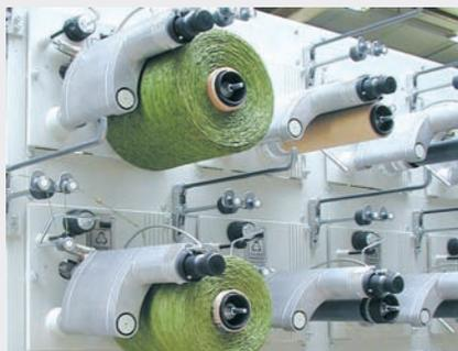
Dans le support du guide-fils destiné à l'enrouleur, les défauts de concentricité et les à-coups sont compensés à l'aide d'embouts à rotule.
