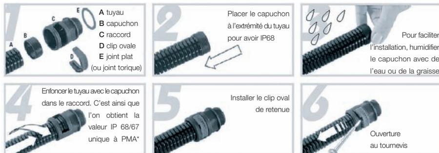
\* Par sécurité, le clip ovale ne peut être placé si le capuchon est mal installé. Respecter les directives du fabricant du joint torique pour l'étanchéité.
