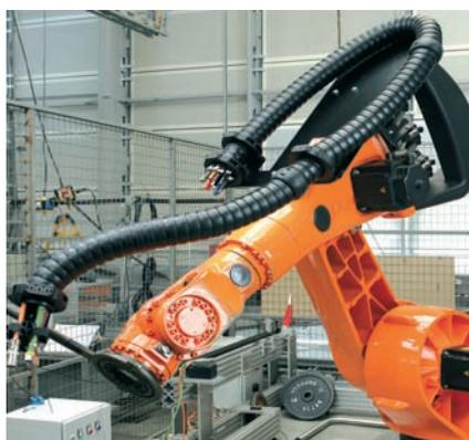
La "Triflex RS" permet un guidage de la Chaîne à mouvements pluridimensionnels parallèle au bras du robot et au plus près de celui-ci
