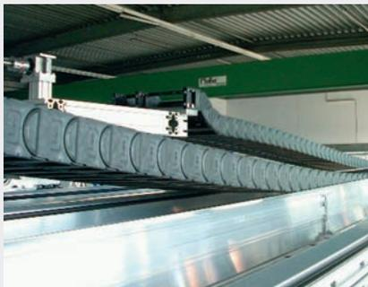
Série E4/4 igus® dans goulotte en aluminium igus® montée sur un pont roulant.
