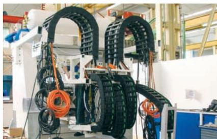
Centre d'usinage : Chaînes Porte-Câbles Série E4, câbles Chainflex®, pièces en tôle et serre-câbles livrés prêts à être mis en place
