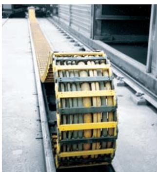
Système E4 dans une usine à béton, exposé à la poussière et aux boues de ciment
