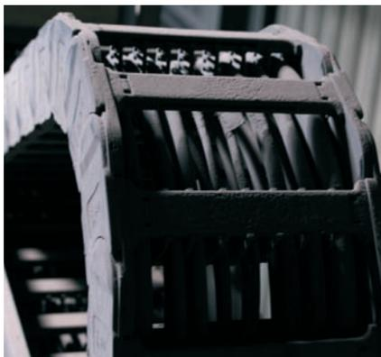
Rol E-Chain® 4040R d'igus® dans une centrale. Course de 46 m, vitesse de 1,5 m/s, masse de remplissage de 5,3 kg/m
