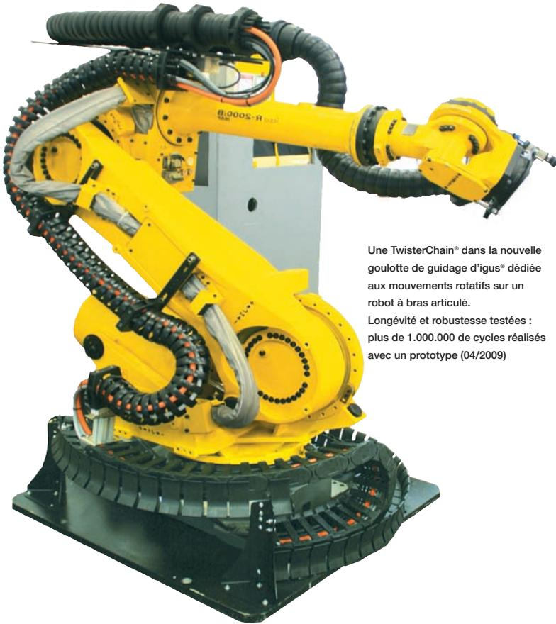
Une TwisterChain® dans la nouvelle goulotte de guidage d'igus® dédiée aux mouvements rotatifs sur un robot à bras articulé.
