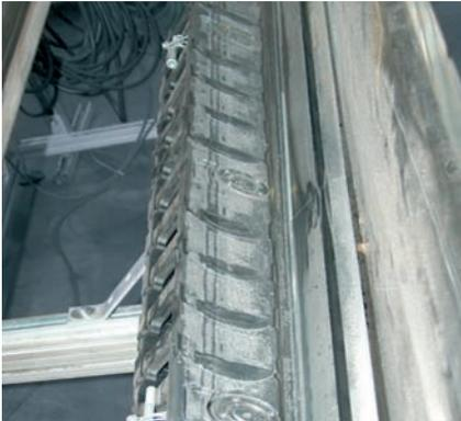
Test d'usure latérale, minimisée avec les bandes de glissement.
