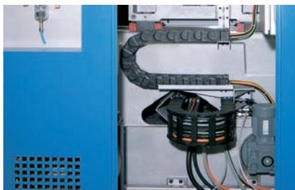
Système de Chaînes Porte-Câbles igus® Système E4 confectionné avec câbles et accessoires sur un centre d'usinage horizontal
