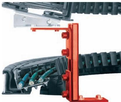
Ce support au sol n'est nécessaire que si le soutien du brin supérieur ne peut pas être fixé sur l'installation (angle de rotation à partir de 180°)
