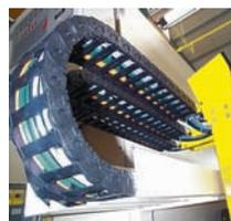
Les câbles Chainflex® permettent d'utiliser le rayon de courbure le plus petit 5 x d
