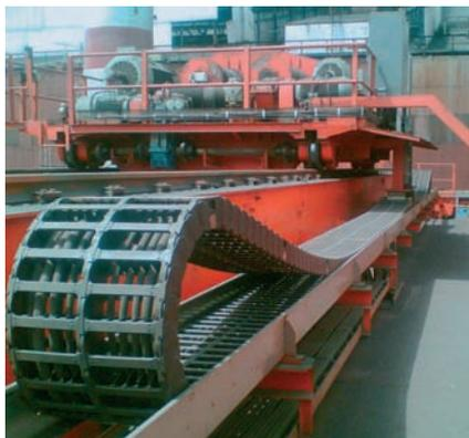
Rol E-Chain® Série 5050R d'igus® dans l'environnement difficile d'une aciérie indienne -  $s = 22\text{ m}$ ,  $v = 1\text{ m/s}$ ,  $a = 1\text{ m/s}^2$
