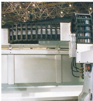
Système E4 d'igus® avec soutien d'un côté
