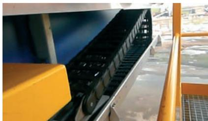
Application réussie avec une Série P4.56 sur une grue RMG. Course de 130 m à une vitesse de 150 m/min. Confectionnée avec des câbles de puissance pour moteurs, de commandes et fibre optique Chainflex®. Etude assurée par igus® Cologne
