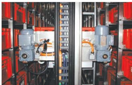
Chaîne igus® E2/000 confectionnée avec câbles Chainflex® CF27, CF11 et CF.INI dans un magasin d'outillage
