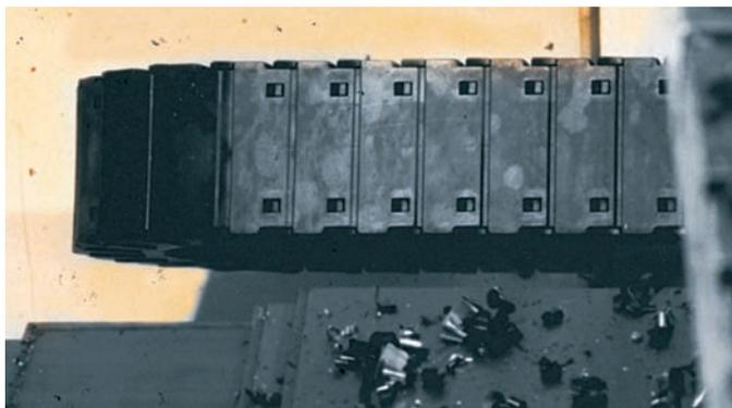
Gaines igus® en présence de copeaux sur une machine-outil
