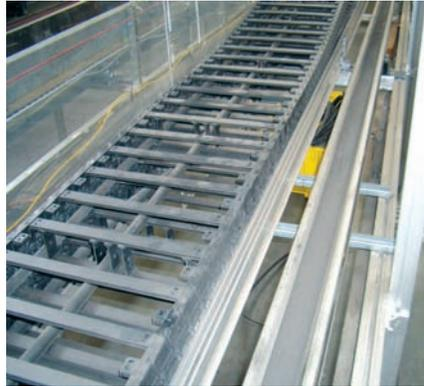
La goulotte de guidage en aluminium igus® est utilisée depuis 2005 en standard pour les tests. Montage de test "axe 1" : vitesse de 1,5 m/s, course de 18 m, distance parcourue jusqu'à présent : env. 50.000 km (test en cours depuis 2005)
