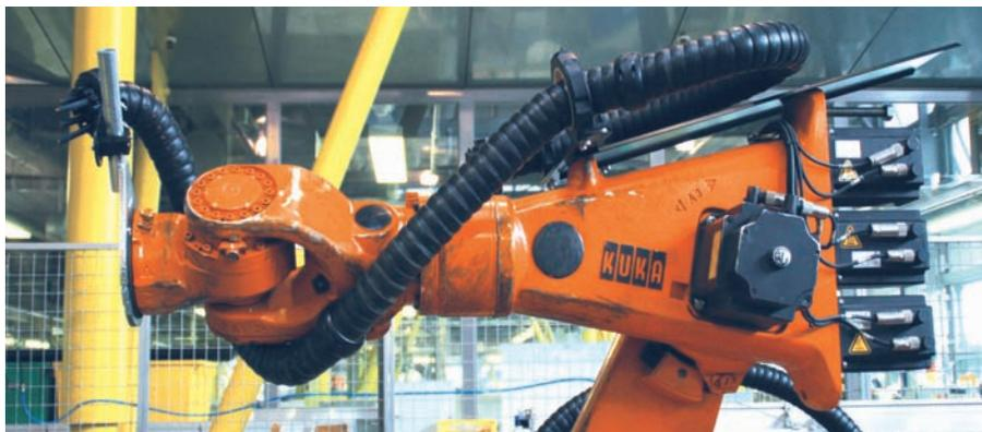
Triflex® RS permet à la Triflex® R d'assurer des mouvements pluridimensionnels guidés au plus près du robot. Un ressort de rappel intégré génère la pré-tension dans un sens pour éviter la formation de boucles. En option : Triflex® RS avec couvercle
