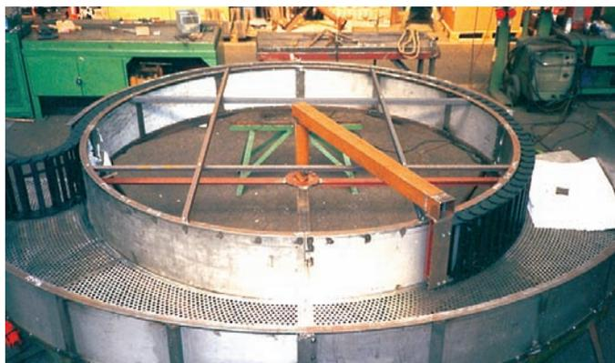
Mouvement circulaire avec Système E4 à RBR - diamètre de 6000 mm, rotation de l'anneau intérieur
