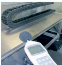
Contrôles du niveau sonore dans nos propres cabines
