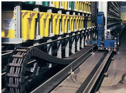
Transstockeur équipé de la Série 350 et de câbles Chainflex® - longueurs de courses allant jusqu'à 80 m et vitesse  $v = 4,5$  m/s, E2 medium
