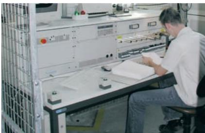
Contrôle de qualité igus® avec des bancs d'essais de tension assistés par ordinateur
