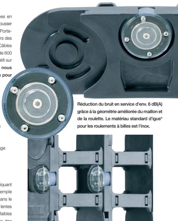
Réduction du bruit en service d'env. 6 dB(A) grâce à la géométrie améliorée du maillon et de la roulette. Le matériau standard d'igus® pour les roulements à billes est l'inox.
