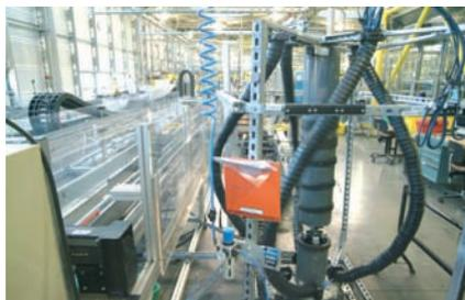
Test des composants : contrôle de la résistance à la torsion des câbles
