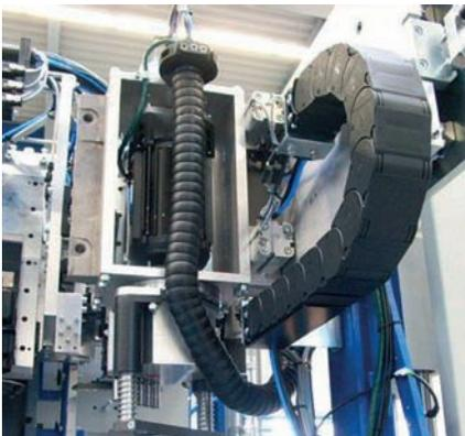
Gaine E2 et Triflex® R d'igus® dans un centre d'usinage
