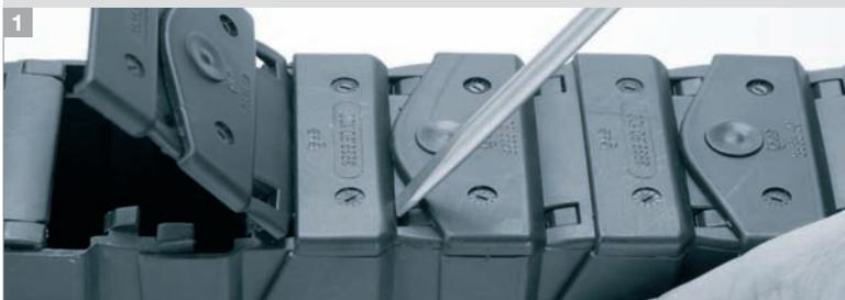
Pour les Séries ouvrables 352 et 353 : introduire le tournevis dans les ouvertures et ouvrir le couvercle en faisant levier
