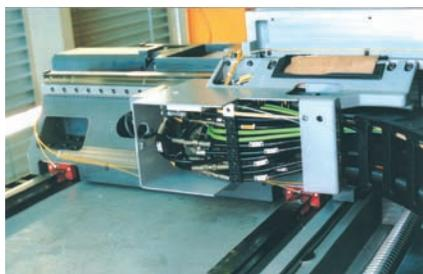
Chaîne Système E4, câbles Chainflex®, pièces en tôles et serre-câbles igus® sur un centre d'usinage
