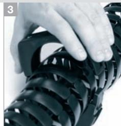
Montage simple. Ouvrir l'élément de fixation, insérer la Chaîne et le refermer. Pour ouvrir, introduire un tournevis sur le côté et faire lever.
