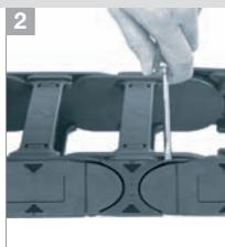
Placer un tournevis dans la rainure de la partie latérale et détacher en faisant lever
