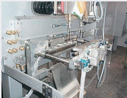
Palier Lisse en iglidur® Z. Température d'emploi en continu allant jusqu'à 160°C dans la poutre de scellage d'une ensacheuse.
