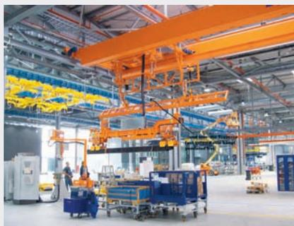
Chaîne Porte-Câbles E4 en position zigzag dans un pont roulant. Les différentes séries E4 garantissent une bonne flexibilité en fonction de l'installation.
