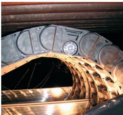
Rol E-Chain® 5050HD d'igus® dans une gouttière en alu d'igus® = 75% de force d'entraînement en moins
