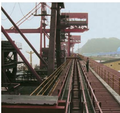
Série 4040R pour le déchargement de charbon. Course de 190 m, vitesse de 0,5 m/s, masse de remplissage de 8,05 kg/m
