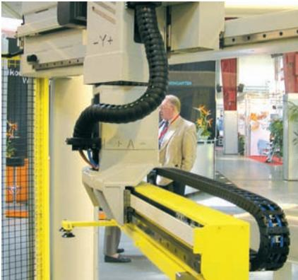
Système E6 et Triflex® R TRE d'igus® sur un portique YZ
