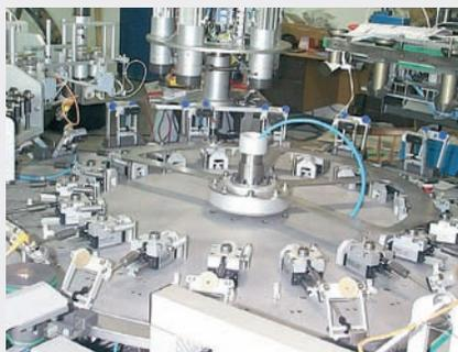
Rotules lisses igubal® : longue durée de vie et compatibilité alimentaire dans une machine de conditionnement.
