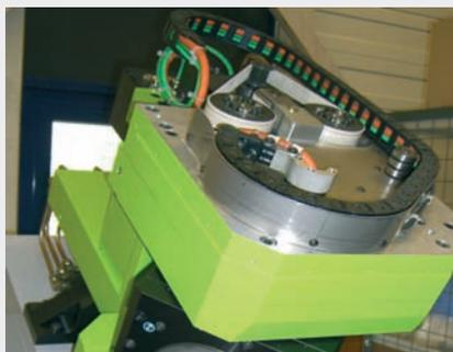
E2 mini, série B15 - La broche moteur a un angle de rotation d'environ  $210^\circ$ .
