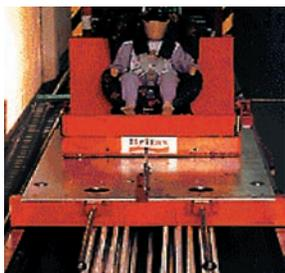
Installation de crash-test : vitesse de 22 m/s
