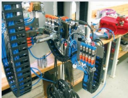
Chaîne Porte-Câbles Série E2/000 - insensible aux saletés et compacte - ici intégrée dans une machine de façonnage de pièces de monnaie.
