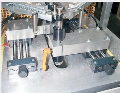
Fabrication de cadres de fenêtres en aluminium. Positionnement des têtes de fraisage assuré par des tables linéaires SHT autolubrifiantes.
