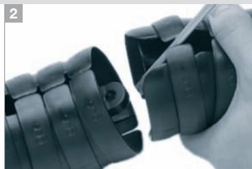
Introduire un tournevis dans l'ouverture de la cuvette, par le haut, et faire lever vers le bas.
