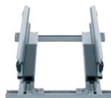
● **Composants, goulotte "Basic"** : ① Partie latérale, aluminium, 2 m ② Bande de glissement, plastique, 2 m ③ Bandes latérales, plastique, 2 m (sans bande de sur demande) ⑩ Optionnellement : profilé amortissant, caoutchouc ● **Composants, kit de montage "Basic"** : ④ Crapaud, aluminium ⑤ Rail en C, acier galvanisé ⑥ Vis M6 x 16 ⑦ Écrou coulissant M6 ⑧ Élément de raccordement, plastique
