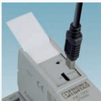
Le raccordement USB permet un accès rapide, par exemple pour le diagnostic.
