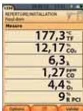
Personnalisez l'affichage de votre analyseur en sélectionnant 4 à 8 paramètres, 4 paramètres sous forme de courbe ou encore la matrice de combustion.
