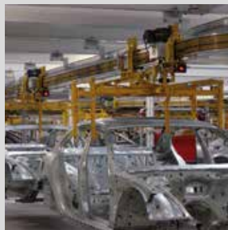
Des convoyeurs aériens transportant des carrosseries dans l'industrie automobile
