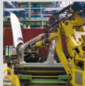
Production automobile : positionnement des éléments de carrosserie grâce aux capteurs de distance
