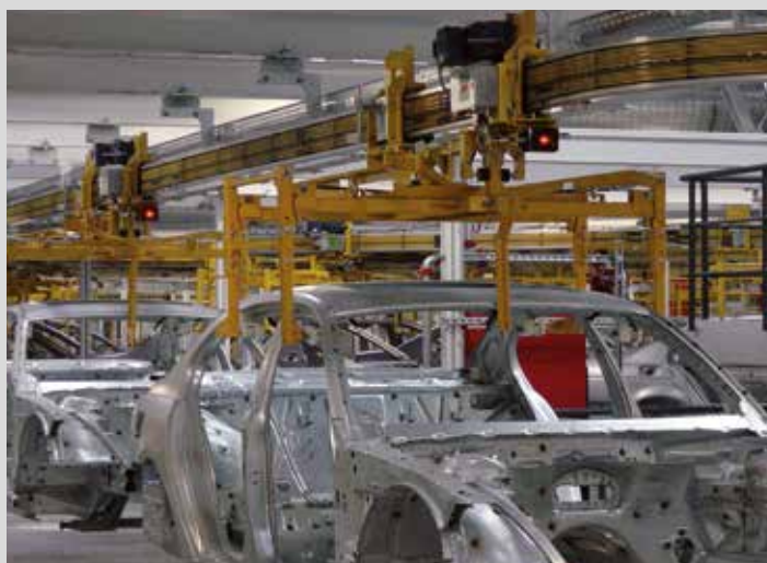
Convoyeurs aériens transportant des carrosseries dans l'industrie automobile
