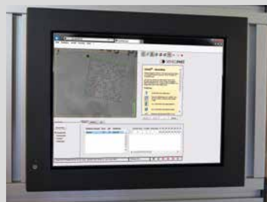
Visualisation des images et résultats par navigateur – le capteur vision SensoWeb VISOR®
